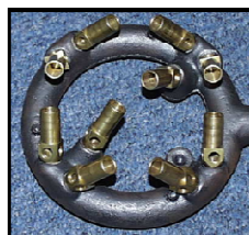
HOŘÁK (nový design) Spotřeba plynu je 1 ku 80 odpařeného plynu. Snadno demontovatelný.
